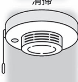
住宅用火災警報器 の設置、点検
