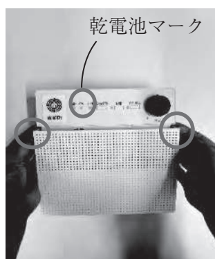
②本体左右側面を軽くつまみ、手前に引き寄せ、上蓋を開ける。
