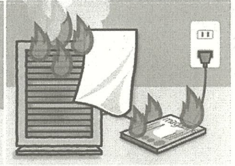
落下したタオルから出火
