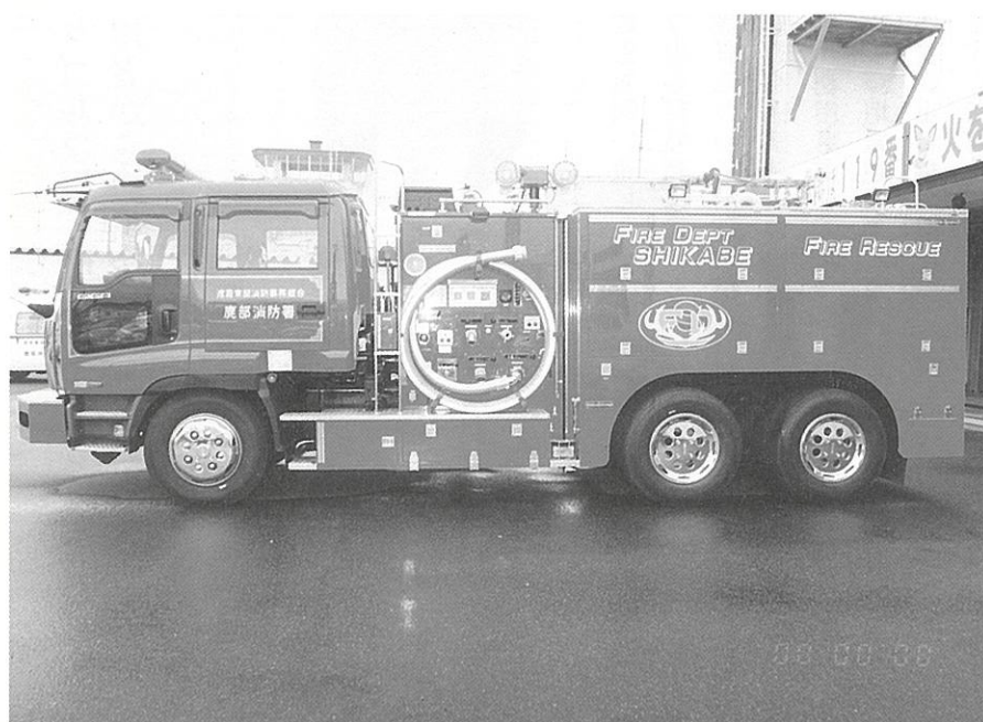
新しく配備された水槽付き消防ポンプ自動車
