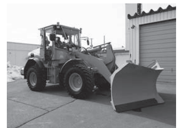
11トン級除雪ドーザー
